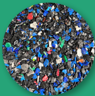
PP inyección cajas
